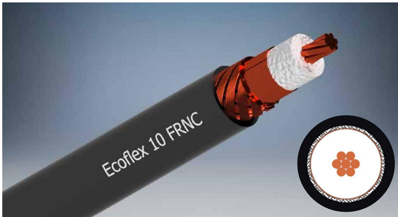
Ecoflex 10 FRNC ist ein flexibles und dabei sehr dämpfungsarmes 50 Ohm Koaxialkabel für den Frequenzbereich bis 6 GHz. Modernste Produktionsverfahren und die Verwendung eines verlustarmen PE-LLC-Dielektrikums mit einem Gasanteil von über 70 % ermöglichen geringe Dämpfungswerte, die bei flexiblen Koaxialkabeln dieser Dimension Maßstäbe setzen.
