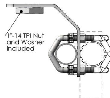
Dieses Produkt ist für kurze AC Antennas Antennen mit einem 1"-14 TPI (Außengewinde) geeignet, z.B. CX4, 4G Multiband usw.
