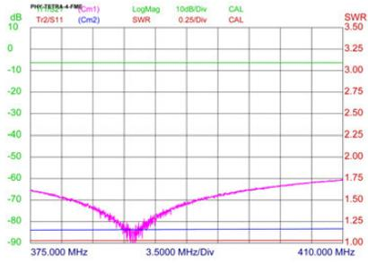
TYPISCHER CURVE ANTENNE MU 3-BZ/TETRA/I (mit 1.5 m Kabel)
