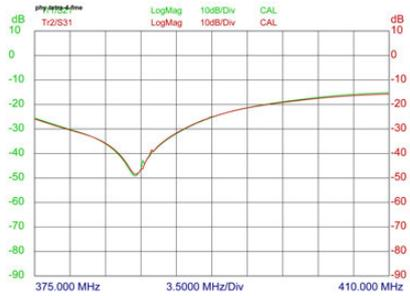
TYPISCHER CURVE ANTENNE MU 1-Z/s (mit 1.5 m Kabel)
