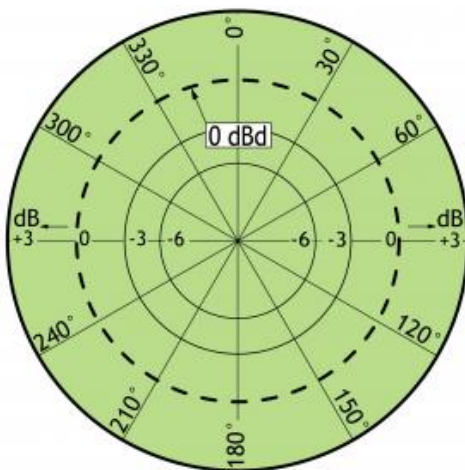
Typisches Strahlungsdiagramm (horizontal)
