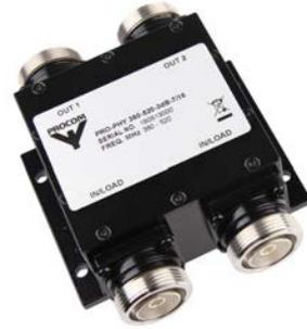
**Koppler Combiner-Modus 1:** Wenn die gleichen Signale an die Eingangspoints mit einer 90-Grad Phasendifferenz angelegt werden, addieren sich die Signale am Ausgangspoint.
