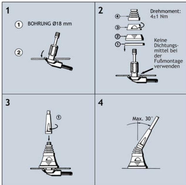
Verwenden Sie **KEINE** zusätzlichen Dichtungsmittel zur Montage.
