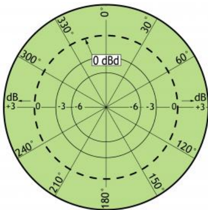
TYP. STRAHLUNGSDIAGRAMM (HORIZONTAL)
