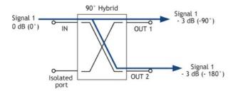
Koppler Combiner-Modus 1: Wenn die gleichen Signale an die Eingangsports mit einer 90-Grad-Phasendifferenz angelegt werden, addieren sich die Signale am Ausgangsport.
